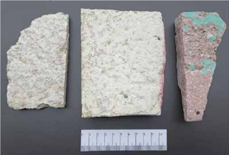
FOT. 1 Próbki elewacyjnych tynków szlachetnych (od lewej strony: tynk szlachetny 1, tynk szlachetny 2, tynk szlachetny 3)
