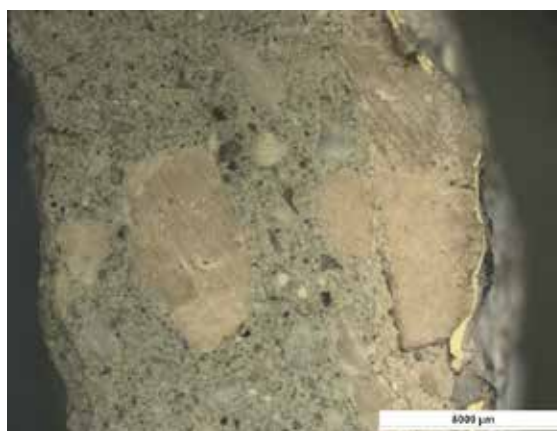
FOT. 2 Tynk szlachetny elewacyjny – próbka 1
