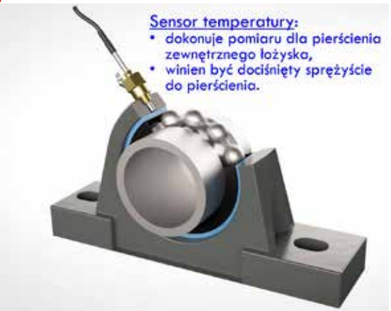
RYS. 5 Pomiar temperatury łożyska (źródło: zasoby autora)
