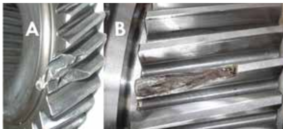
RYS. 11 Częściowe wykruszenie zębów spowodowane asymetrią obciążenia (źródło: zasoby autora)
