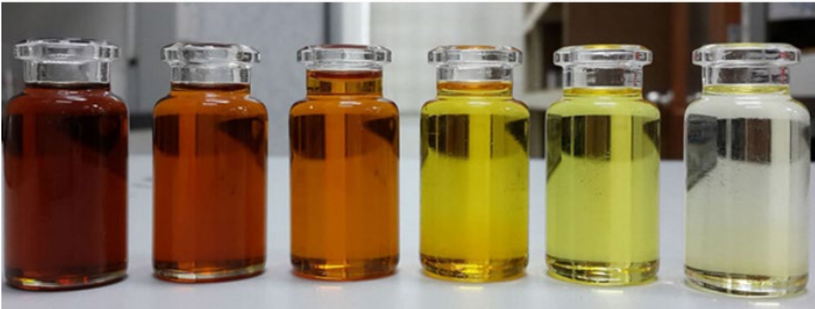
FOT. 1 Barwa eksploatowanego oleju (źródło: ORLEN S.A.)
