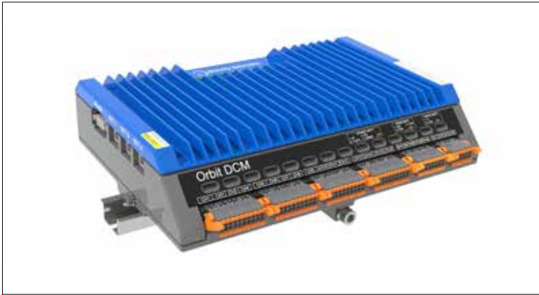
RYS. 1 System monitorowania ORBIT DCM dla złożonych przekładni zębatych z łożyskami tocznymi (źródło: zasoby autora)
